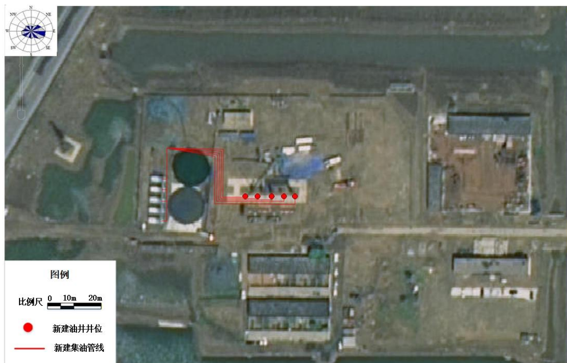
图 3-5 一期工程新建油井及集油管线分布图
