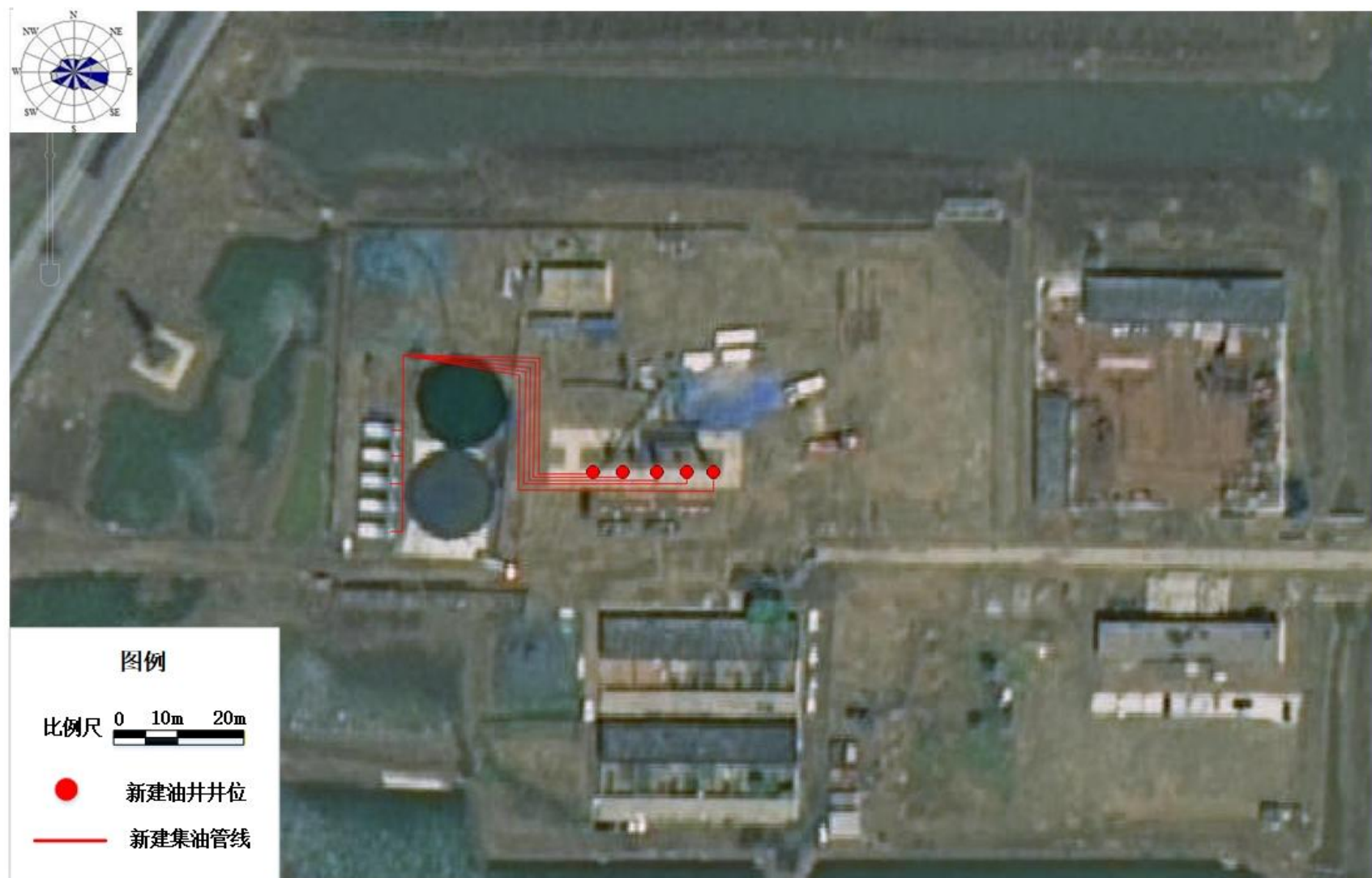
图 3-1 实际建设内容工程布局图
