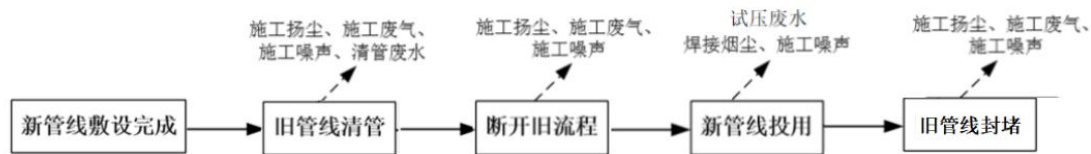
图 3.2-8 旧管线清管及处置工艺流程
