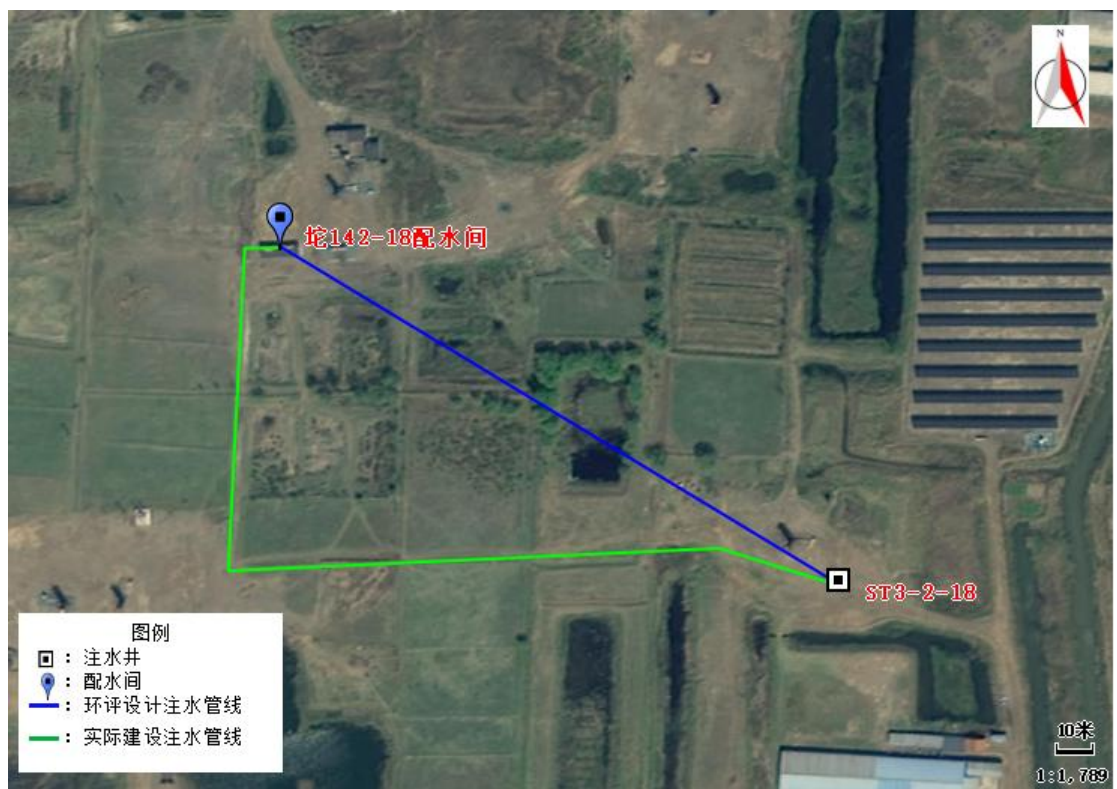
图 3.1-15 管理七区管线走向图（3）
