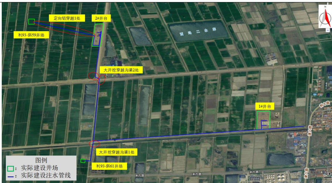
图 2-13 注水管线路由图
