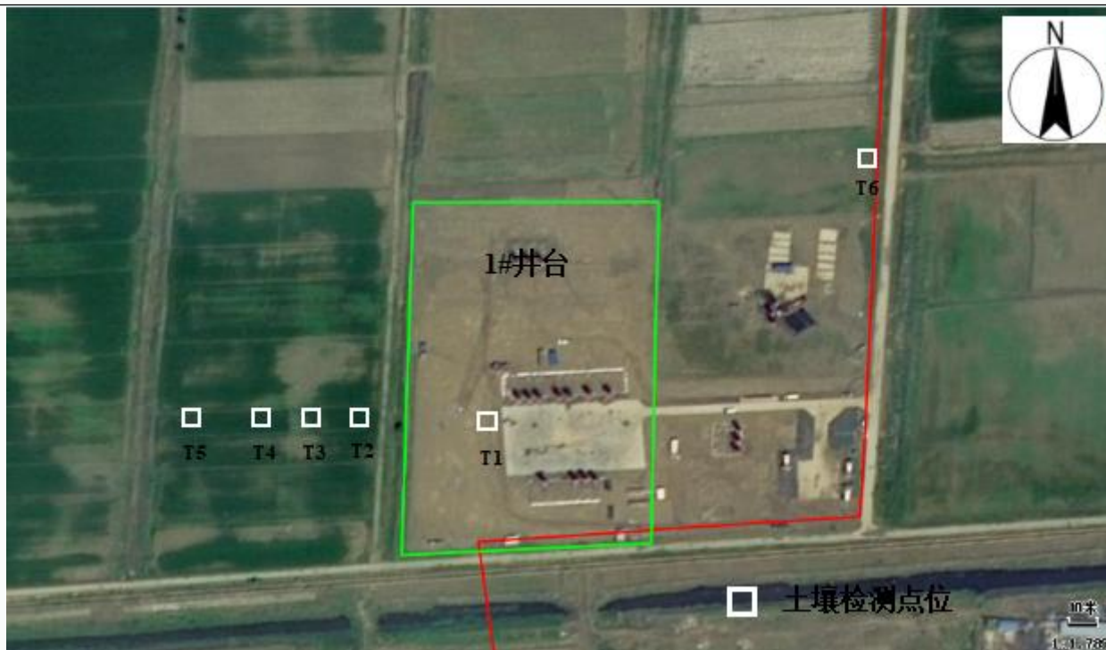
图 5-5 土壤检测点分布示意图
