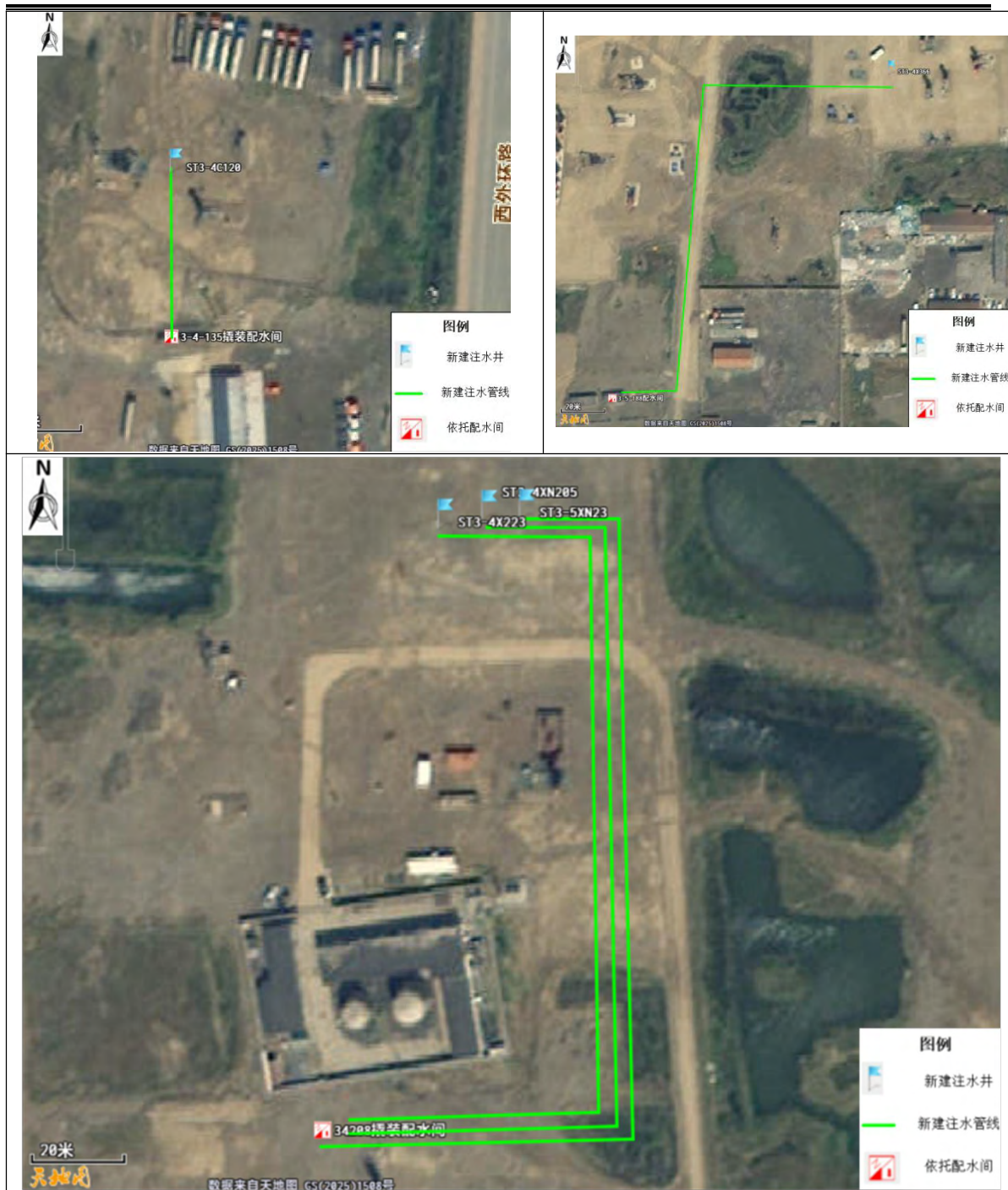
图 3.3-8 本期工程注水管线布局图
