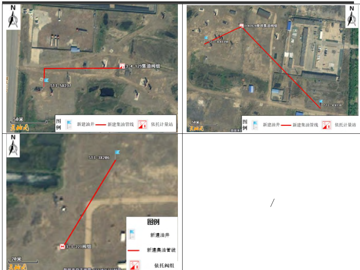
图 3.3-5 本期工程集油管线布局图
