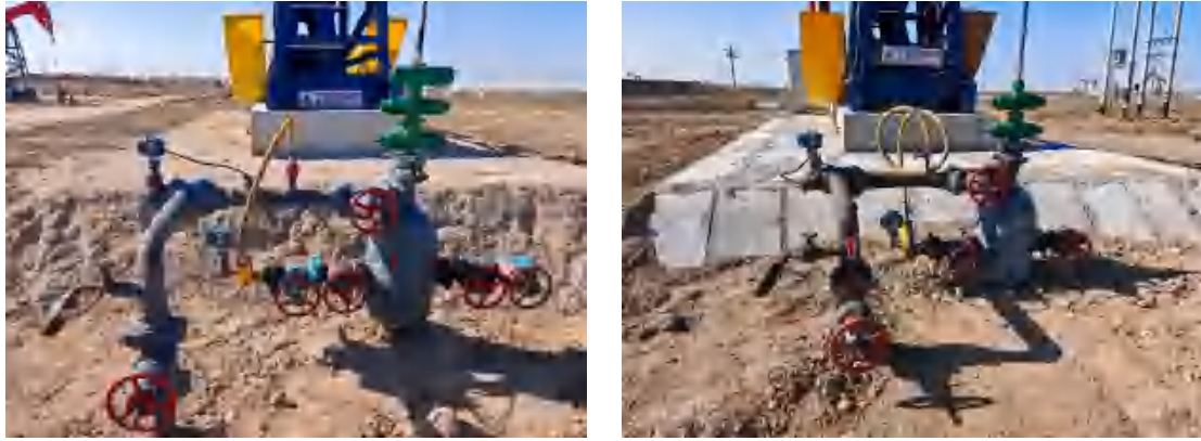
图 3.3-3 油套连通装置
