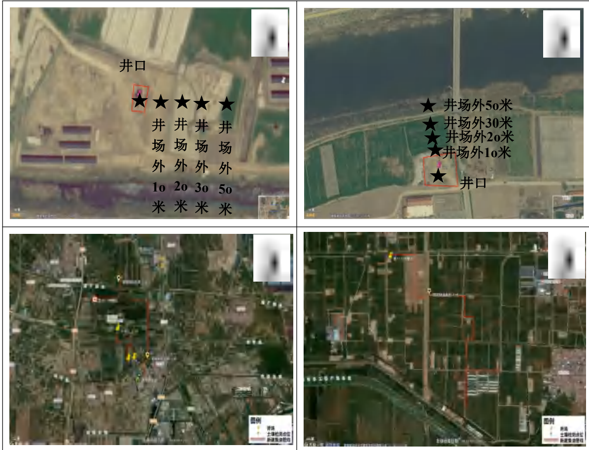
图 6.4-3 项目井场土壤采样布点示意图
