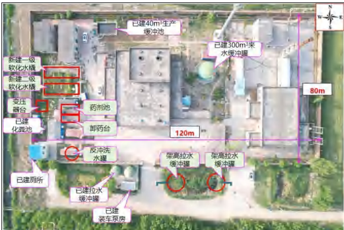
图 3.3-6 改造后2#注气站平面图
