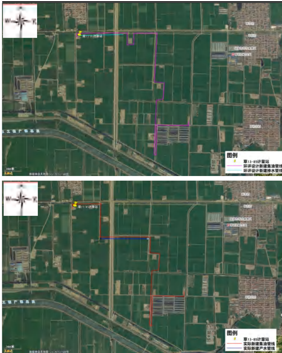
图 3.3-11 环评设计与实际建设管线对比图
