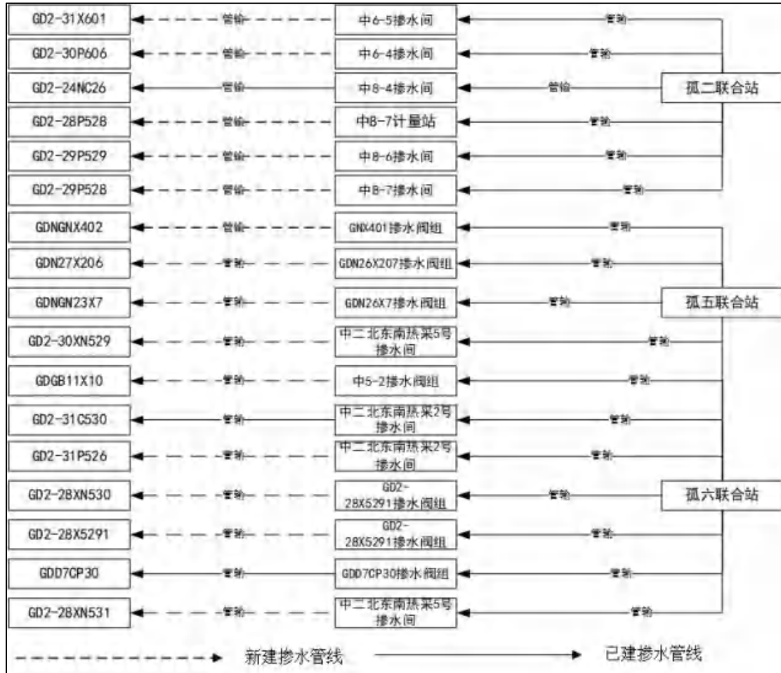
图 3.3-5 二期工程掺水流程示意图
