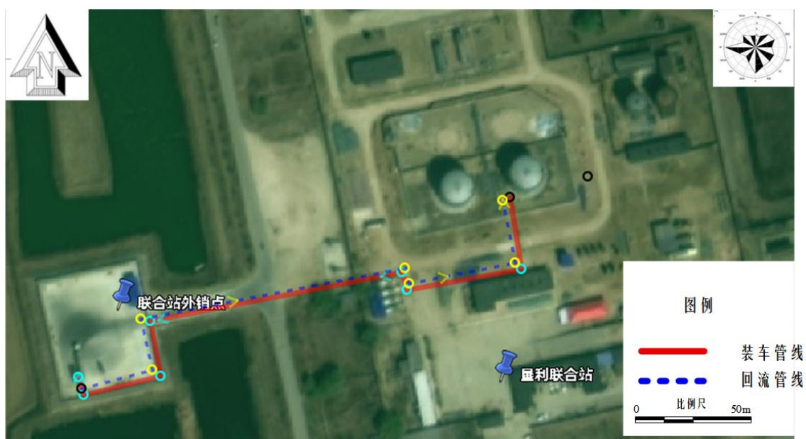
图 3-3（4） 本工程装车、回流管线布局图
