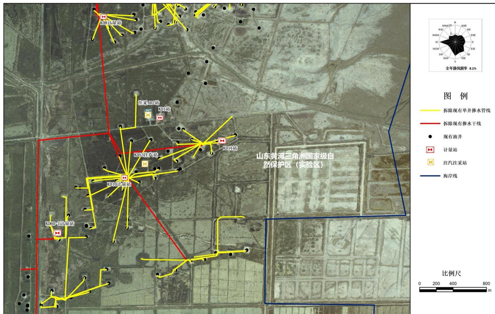
图 3-10 (2) 掺水管线详细路由图
