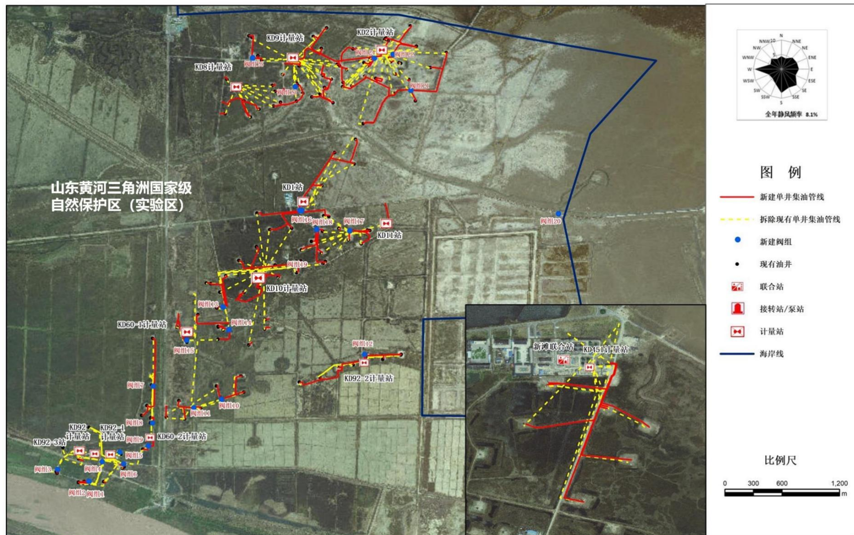
图 3-7 (1) 单井集油管线详细路由图
