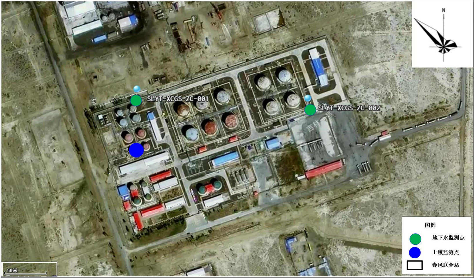
8.12 春风联合站土壤及地下水监测点位示意图
