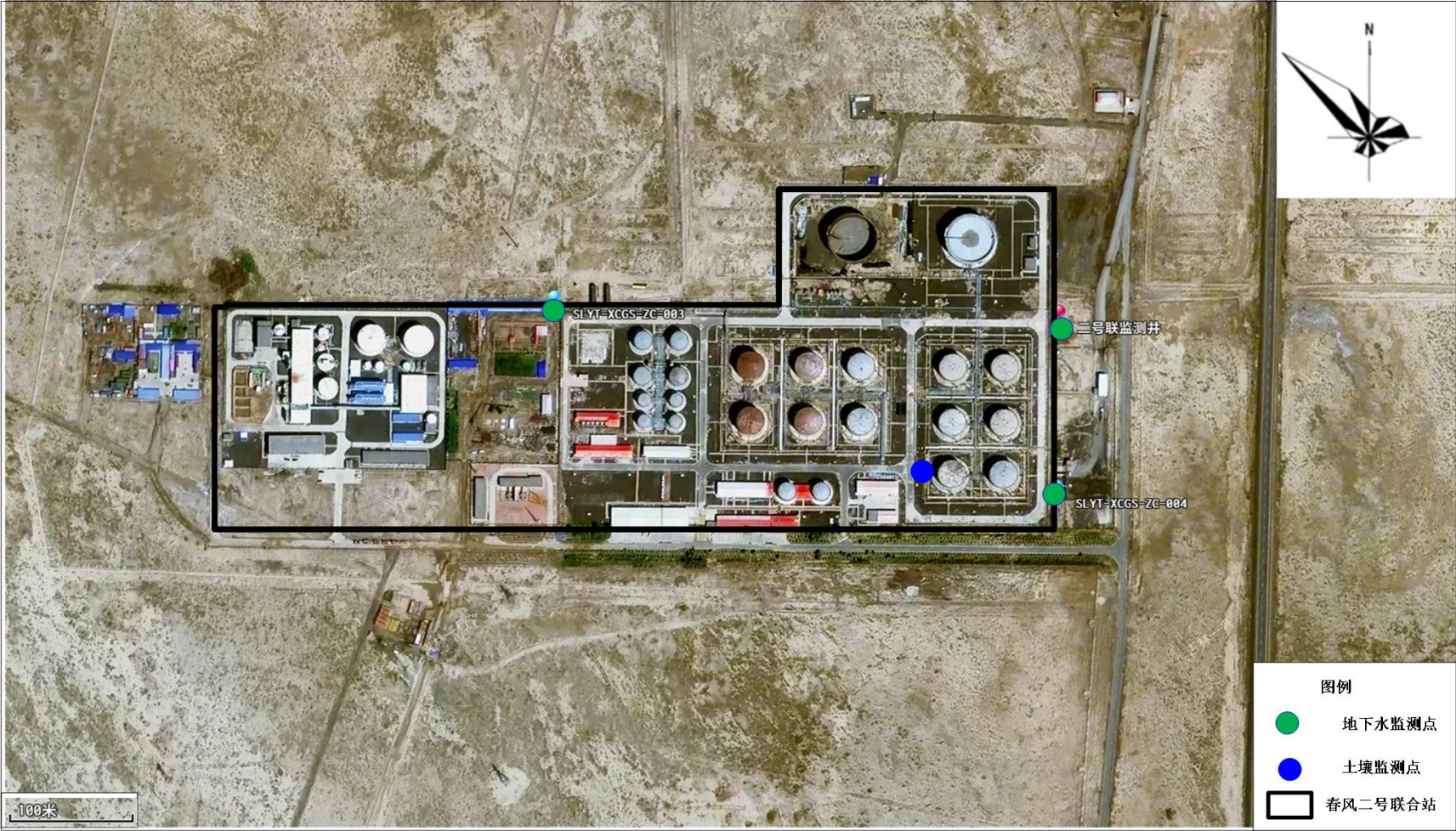
8.13 春风二号联合站土壤及地下水监测点位示意图
