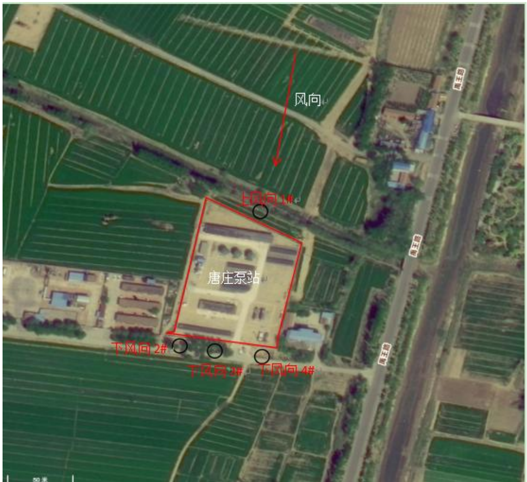
图 3 无组织废气监测点 (根据实际风向调整, 上风向设 1 个参照点, 下风向设 3 个监控点)
