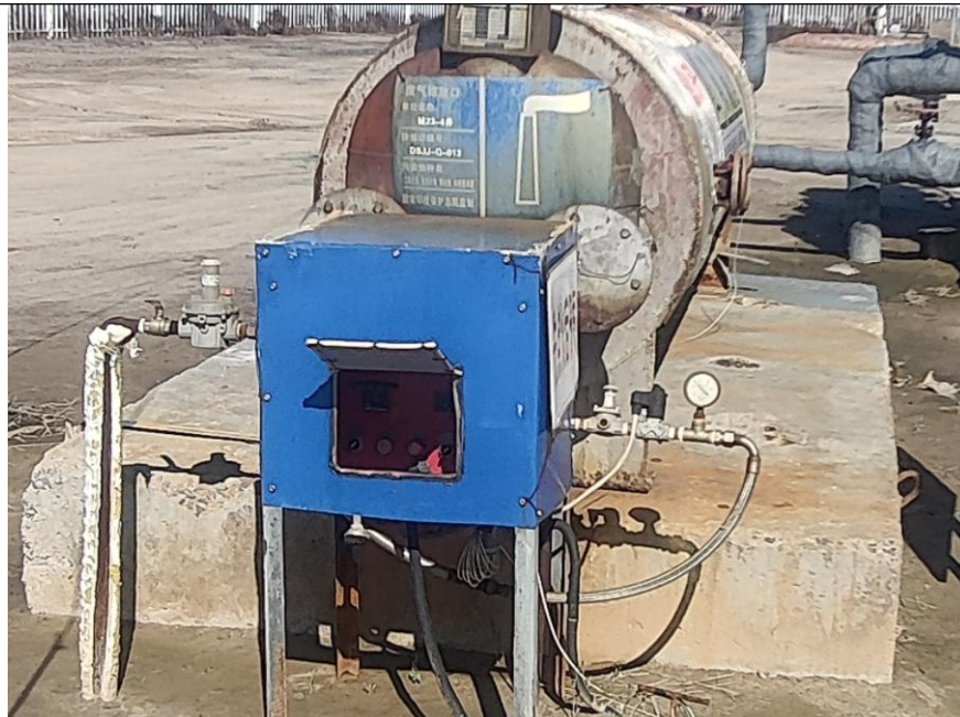
桩23-4井场加热炉低氮燃烧器
