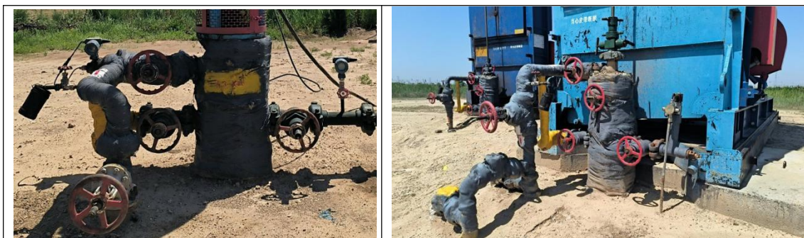
图 5.2-1 油套连通套管气回收装置照片
