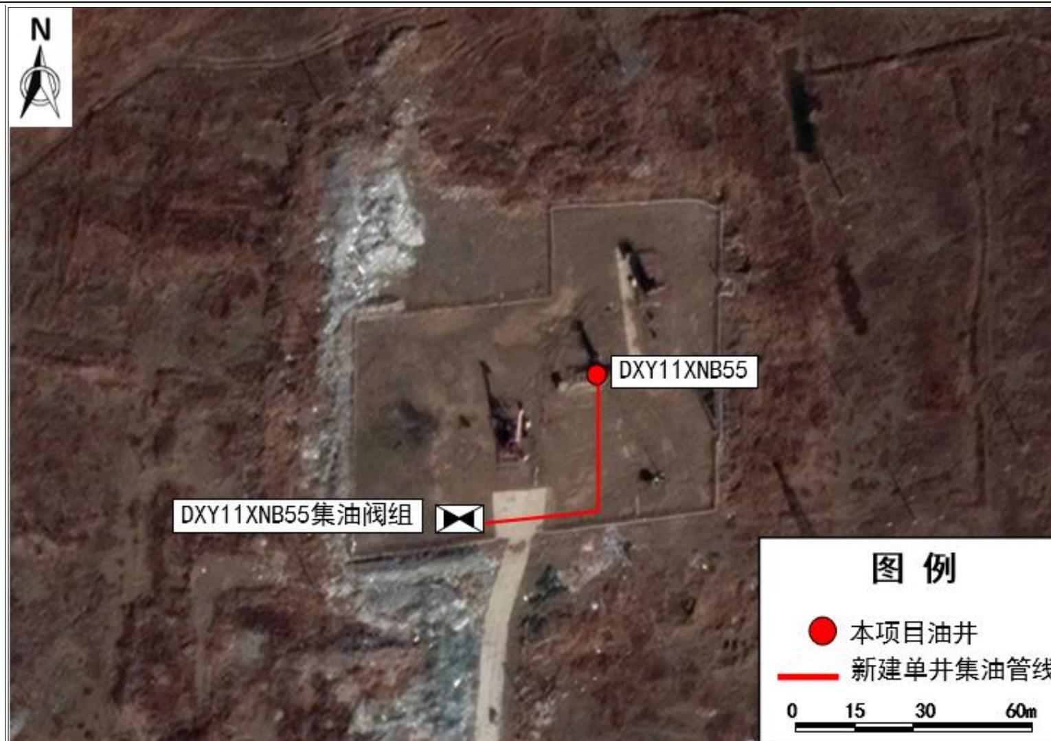
图 3-2 本项目井位分布及地面流程示意图 (2)
