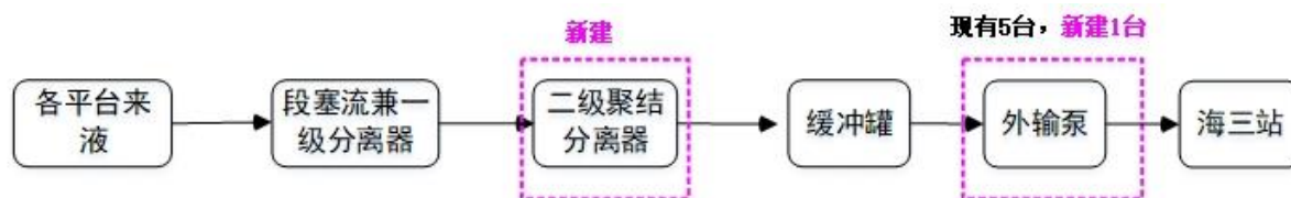
图 3.2-7 中心三号平台油气工艺流程
