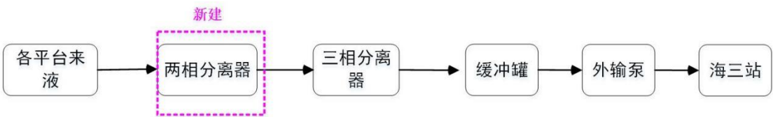
图 3.2-1 中心二号平台油气工艺流程
