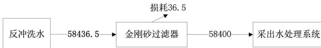
图 3-8 项目水平衡图 (单位: t/a)
