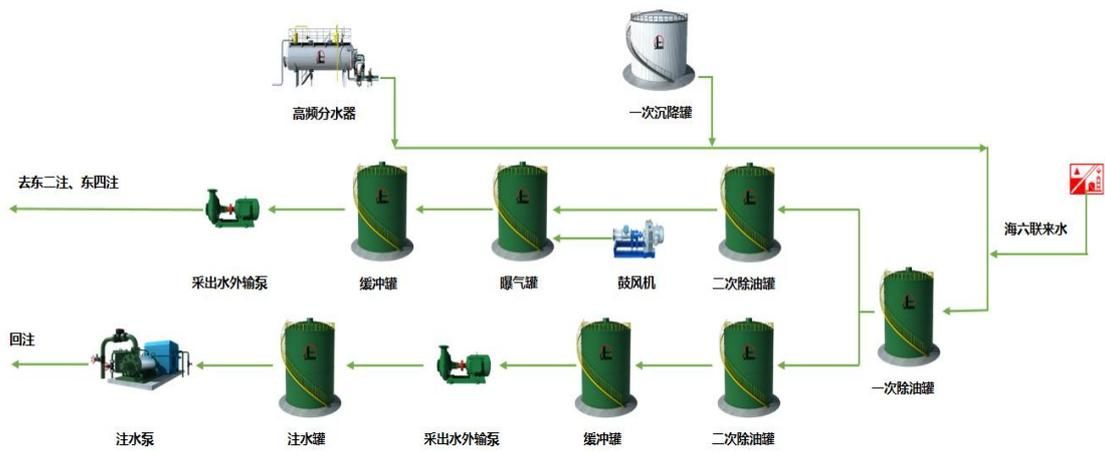
图 4-1 依托的孤东 3#联合站采出水处理系统工艺流程
