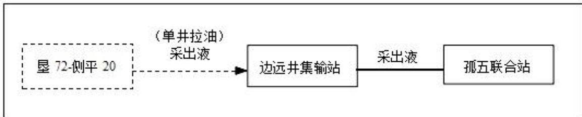
图 3-11 依托边远井集输流程示意图
