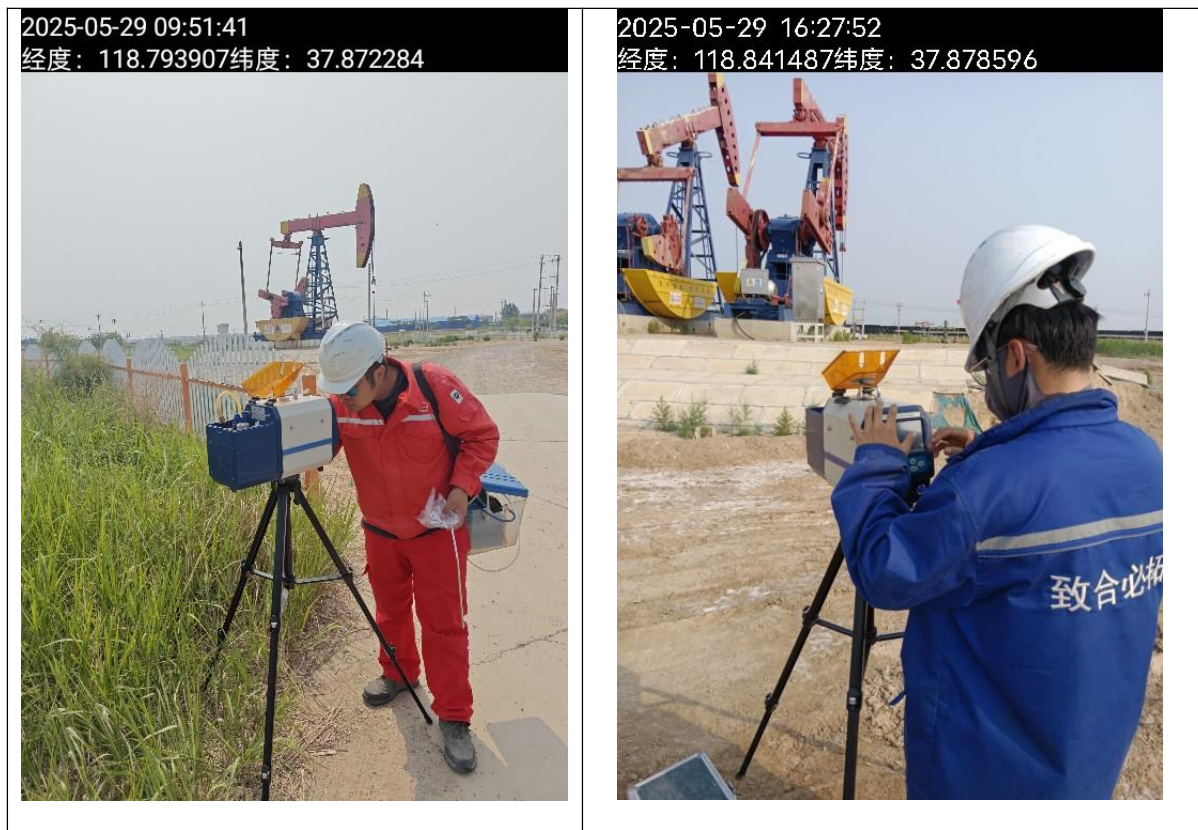
图 6-2 无组织废气现场监测照片
