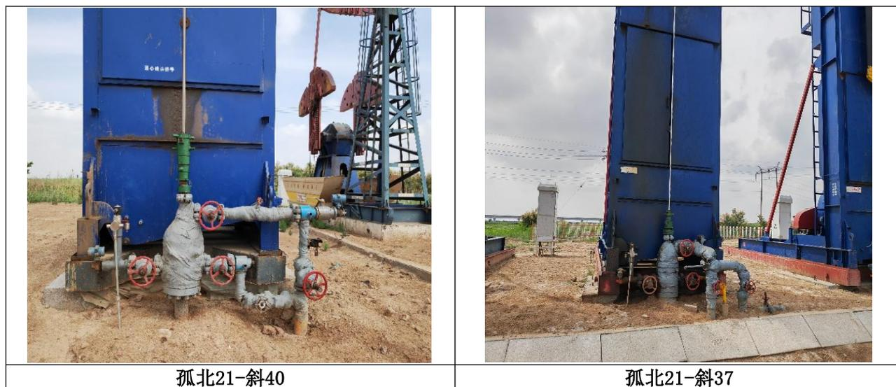
图3.5-1井口套管气回收装置
