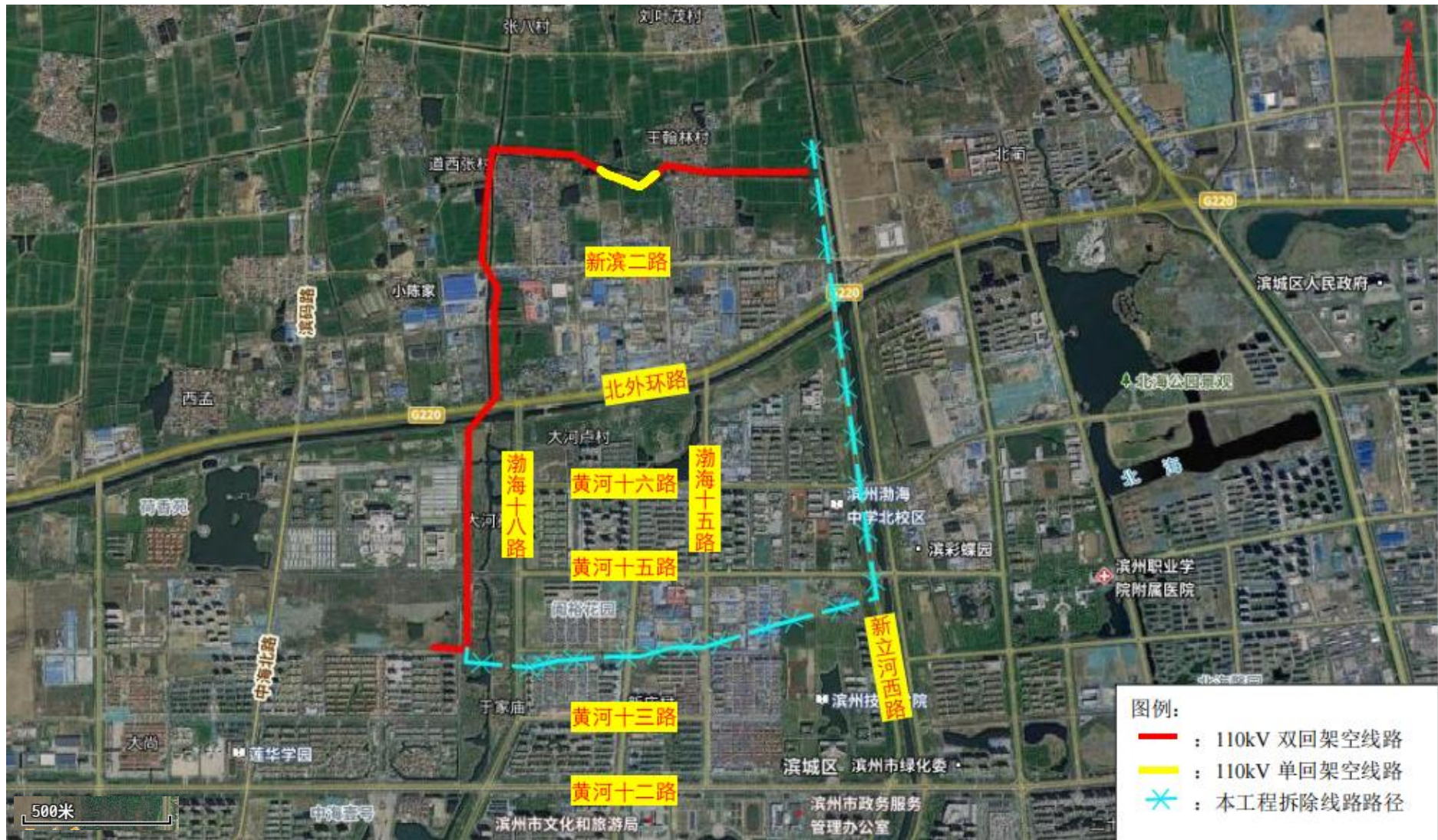
图 4-3 本工程线路实际建设路径图
