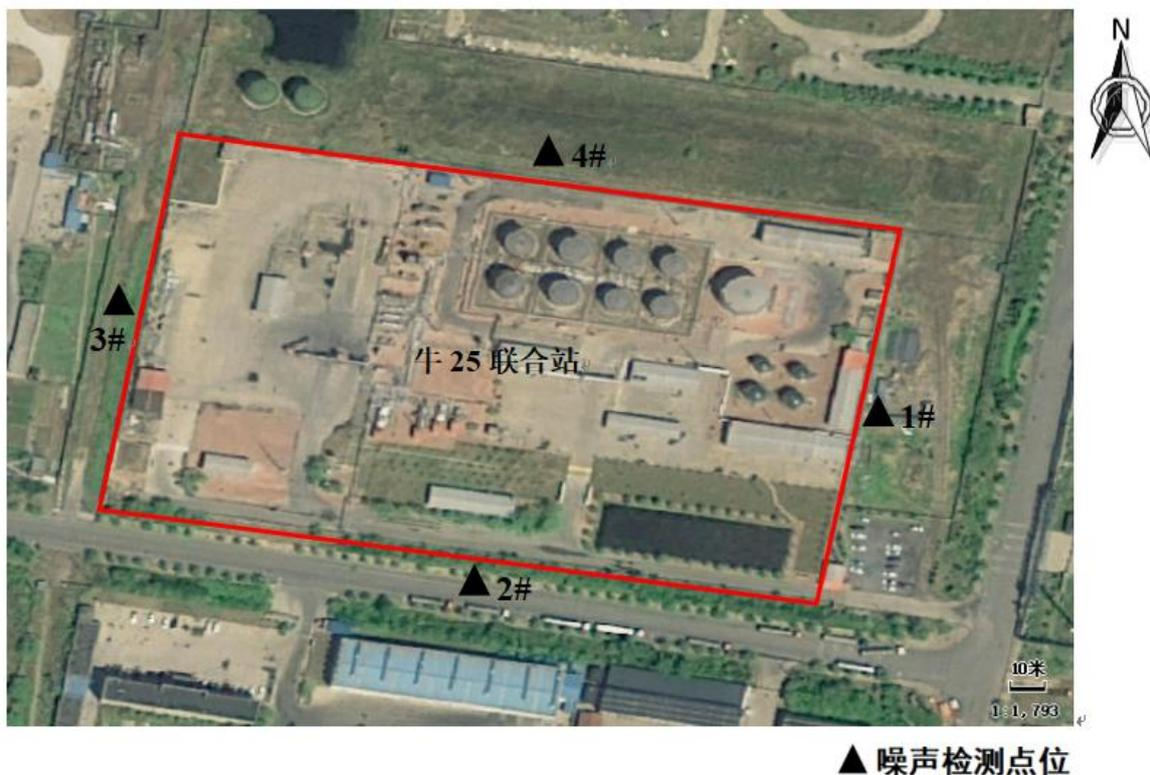
图 6.5-1 噪声监测点位分布示意图
