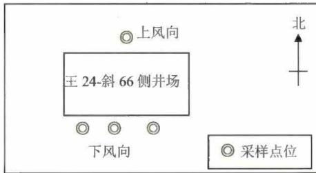
图 1-1 无组织废气采样点位示意图 (2024.9.2)
