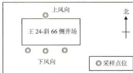
图 1-2 无组织废气采样点位示意图 (2024.9.3)
