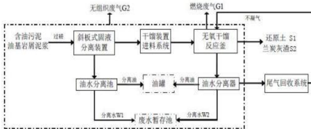
图 2-3 新疆锦恒利废矿物油处置有限公司油基泥浆处理工艺流程示意图
