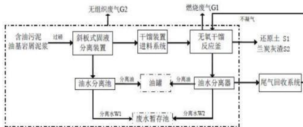
图 2-2 新疆锦恒利废矿物油处置有限公司油基泥浆处理工艺流程示意图
