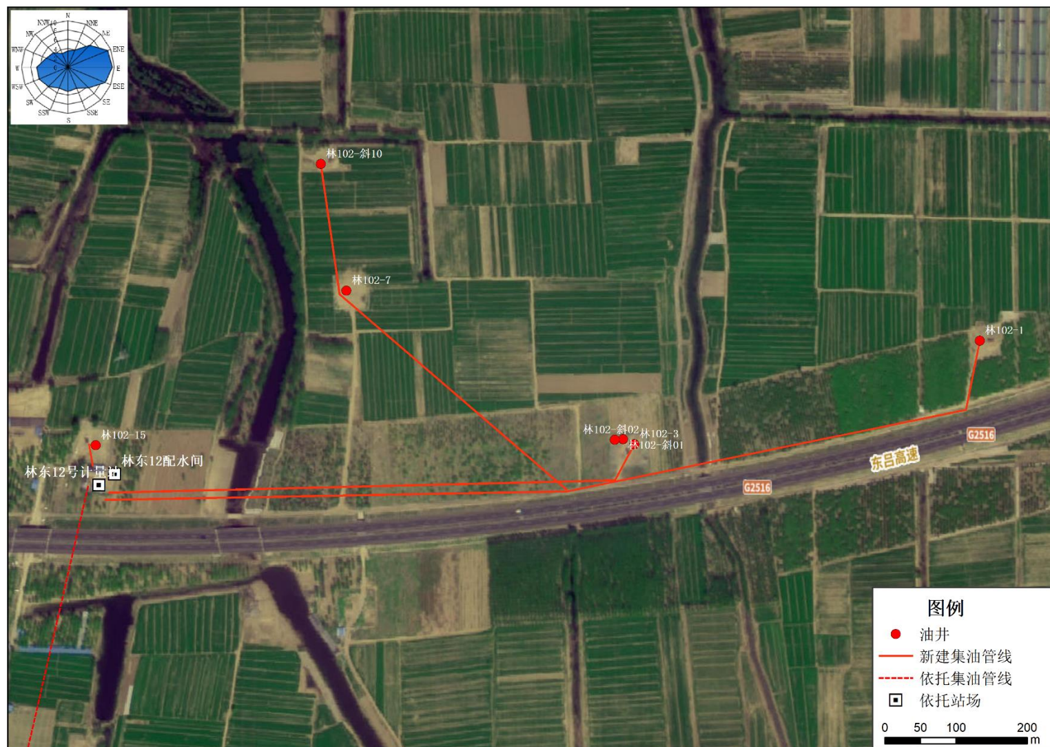
图 3.2-3 本项目新建油井及集油管线分布图 (1)
