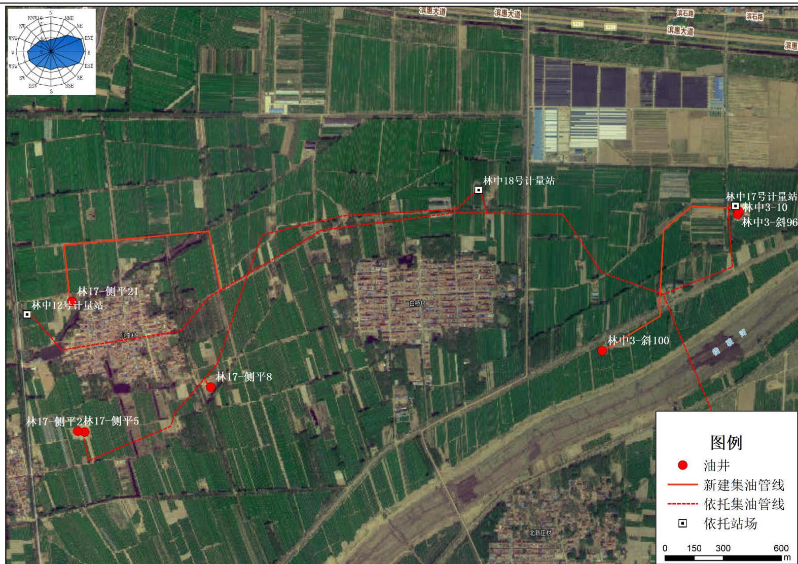
图 3.2-4 本项目新建油井及集油管线分布图 (2)
