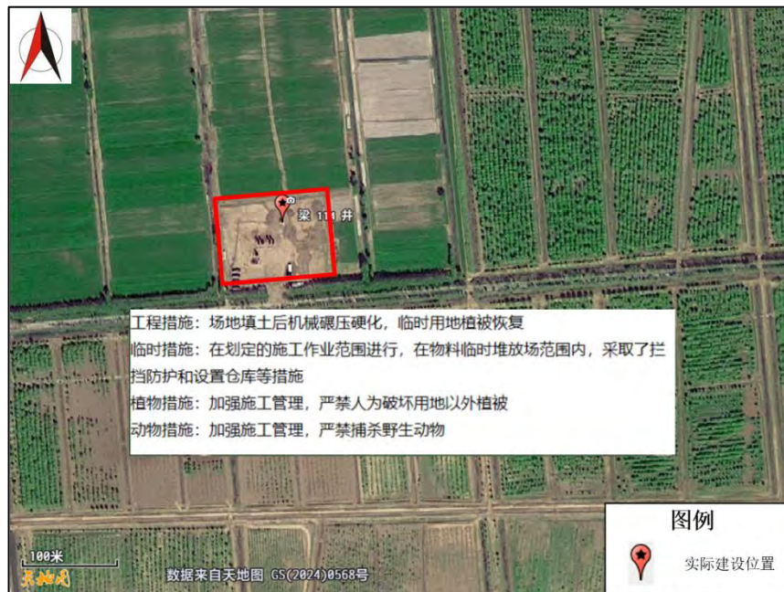
图 2-4 生态保护工程平面布置图
