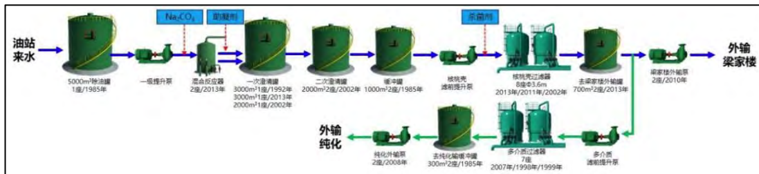
图 2-1 纯梁中心联合站采出水处理站工艺流程示意图
