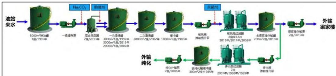
图 2-1 纯梁中心联合站采出水处理站工艺流程示意图
