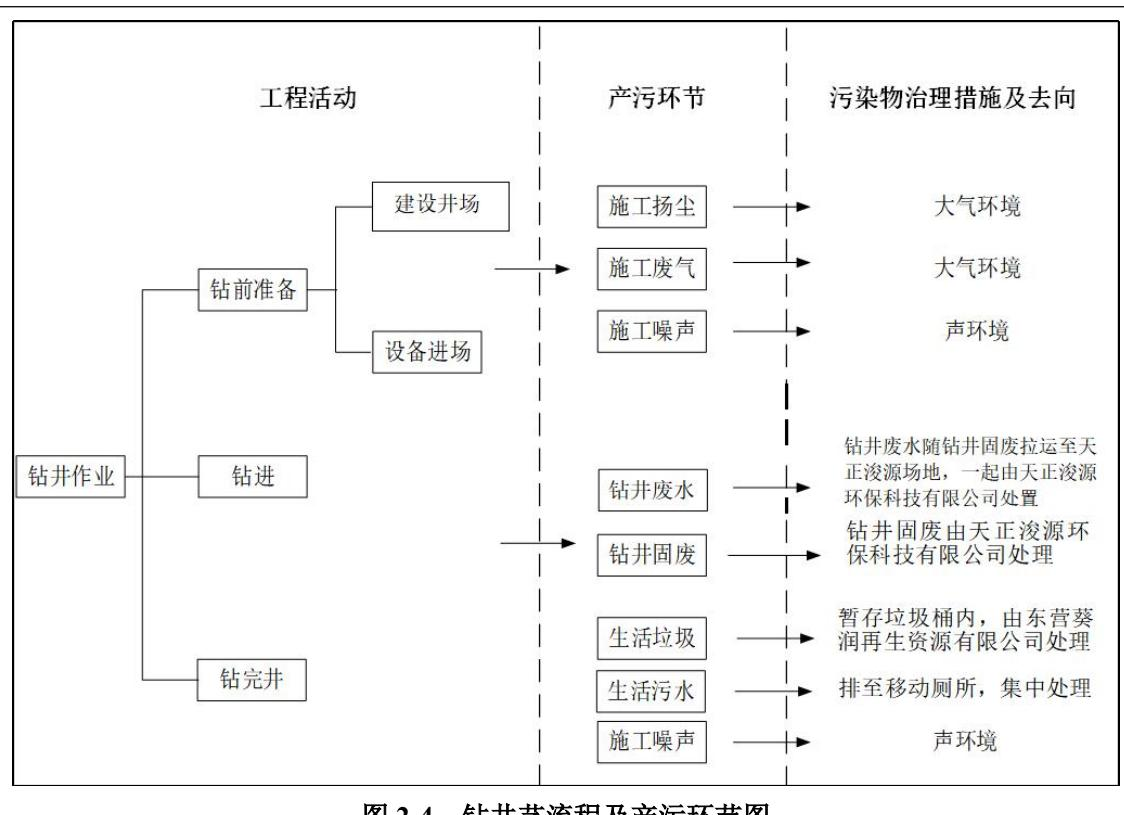
图 2-4 钻井艺流程及产污环节图
