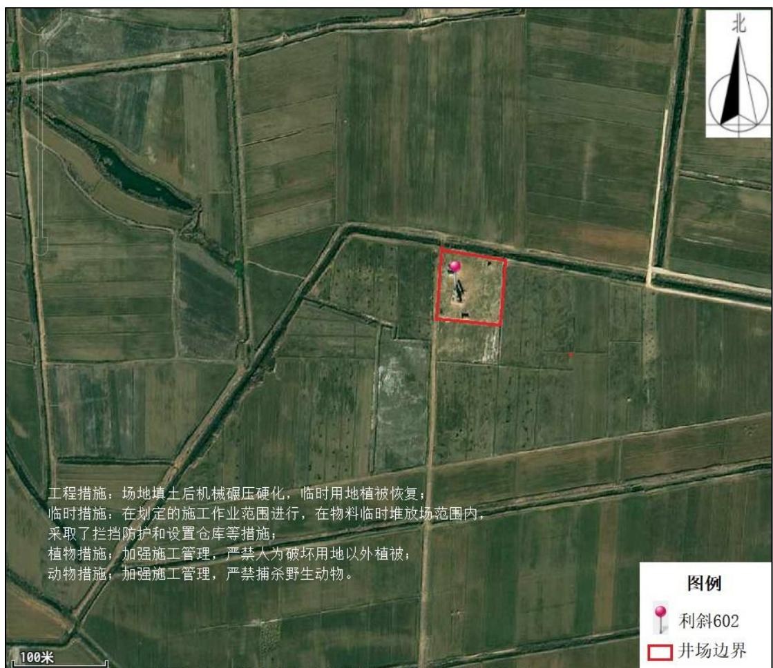
图 2-5 生态保护工程平面布置图
