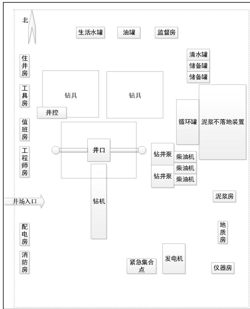
图 2-3 钻井井场平面布置示意图
