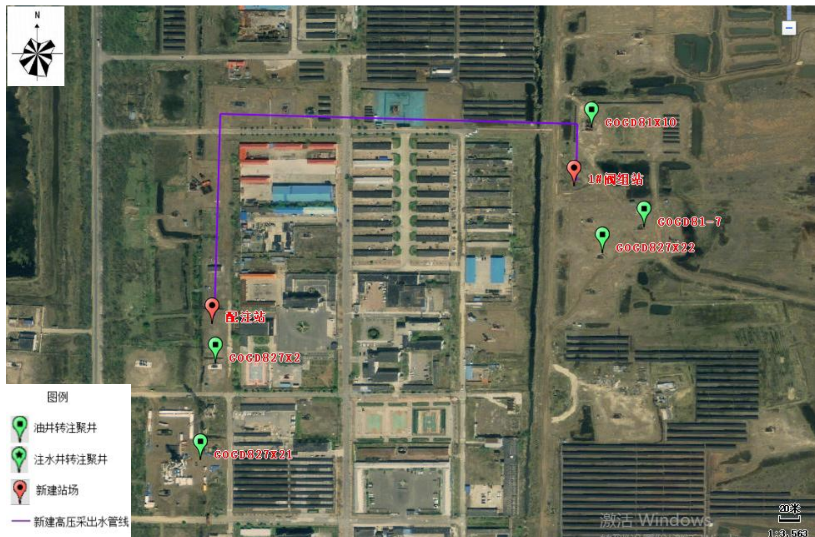
图3.2-19 实际高压采出水管线走向图
