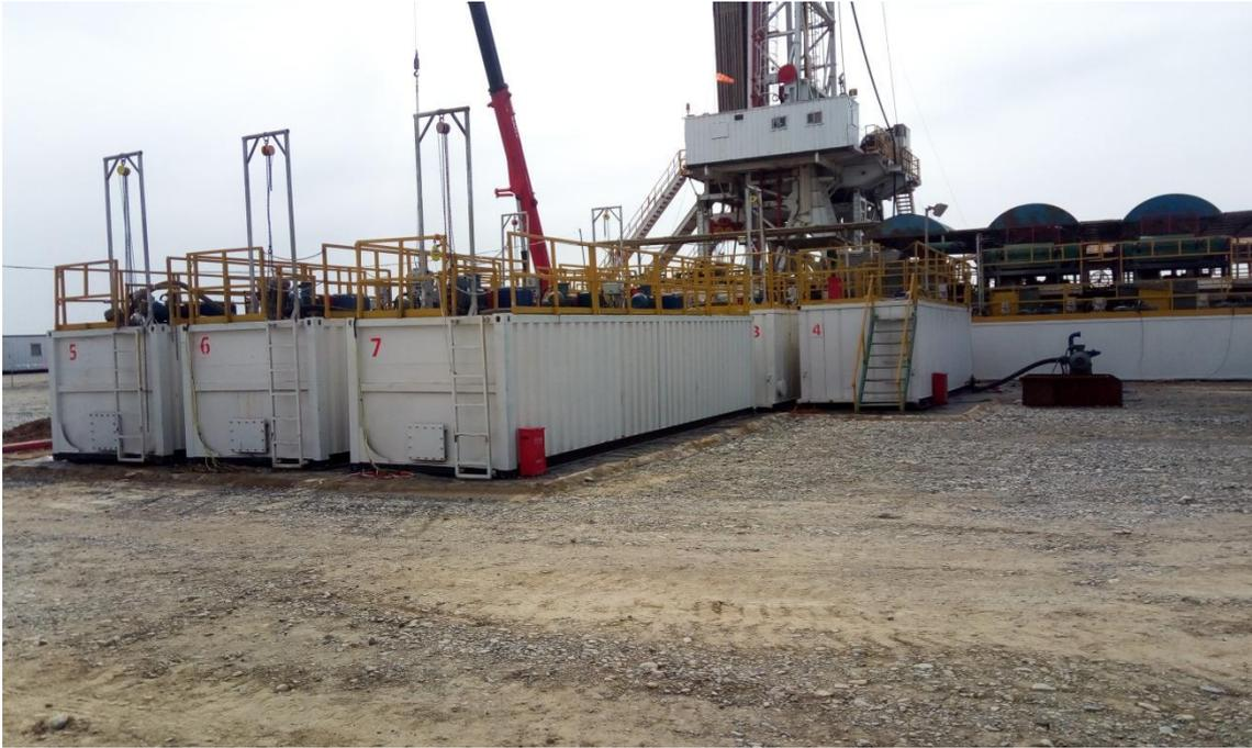
图 8 “泥浆不落地”装置现场照片
