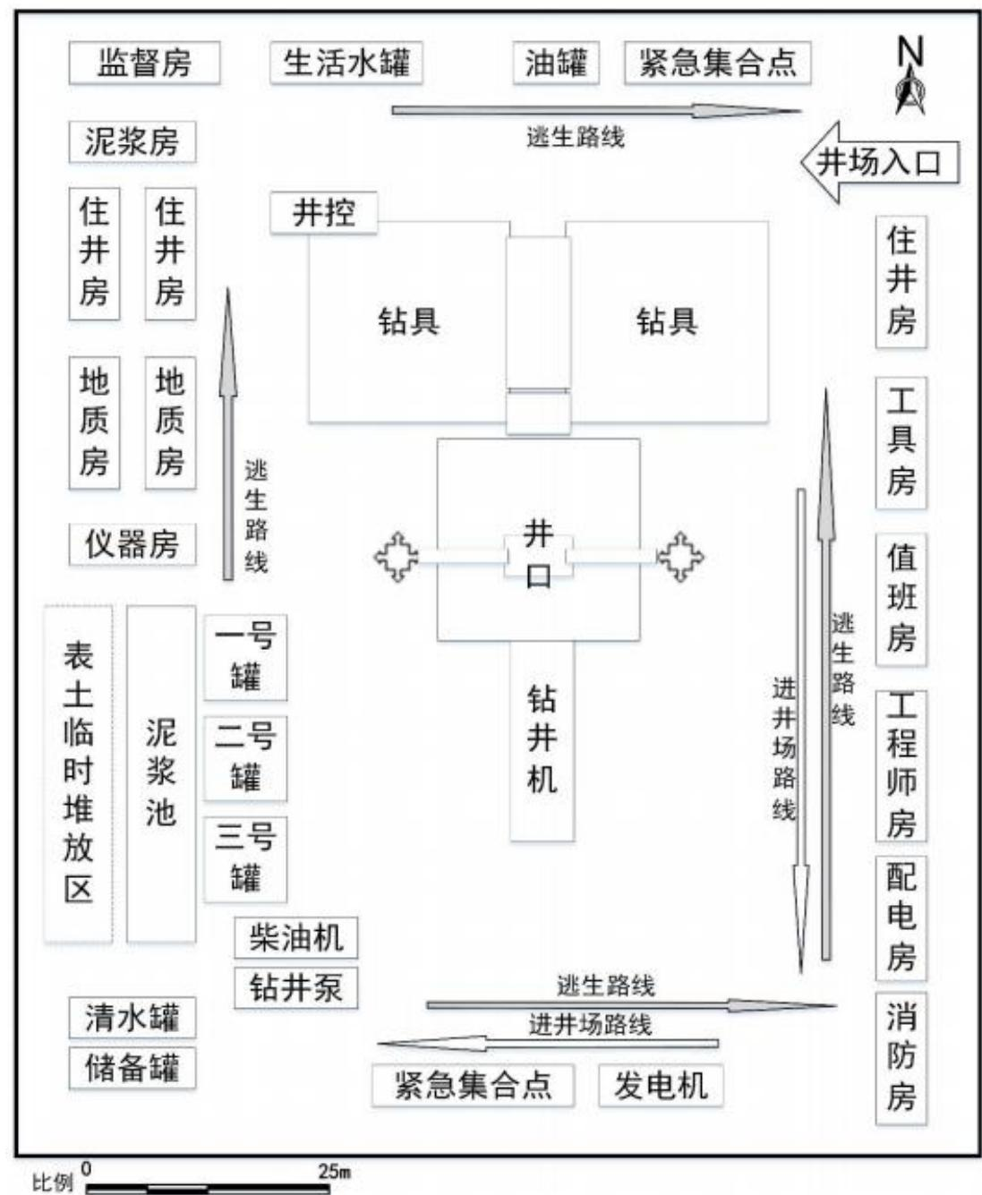
图 2-3 钻井作业井场平面布置示意图
