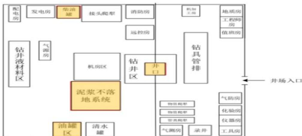
图 4-2 钻井井场平面布置示意图
