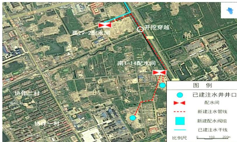
图 2-3 南区东扩注水管线路由图
