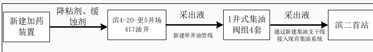
图 2-1 油井集输流程示意图
