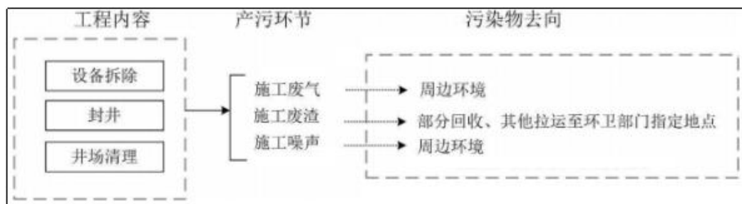
图 4 封井工艺流程及产污环节图
