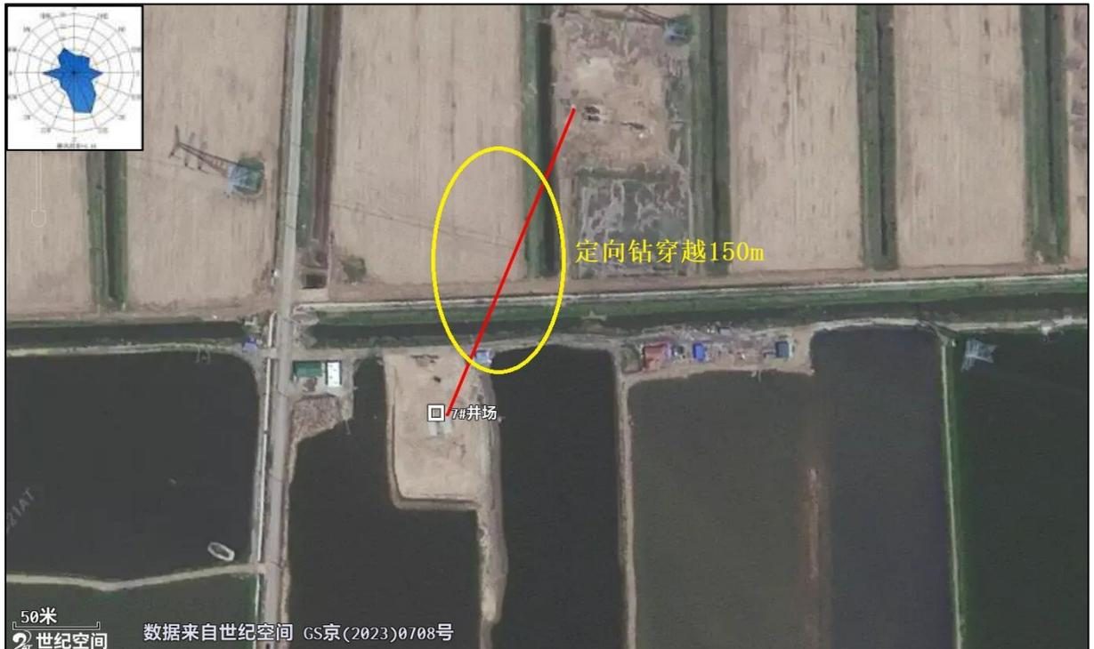
图 3.3-3 管线定向钻穿越
