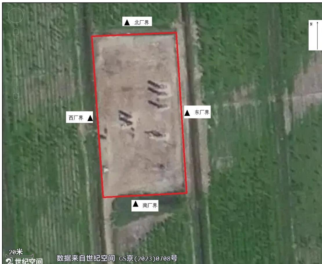
图 6.4-3 典型厂界噪声监测点位示意图（义 184-斜 23、29、34、35、36、42、43、44 井场）
