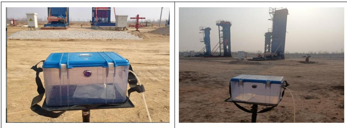
图 6.4-2 典型无组织废气采样照片
