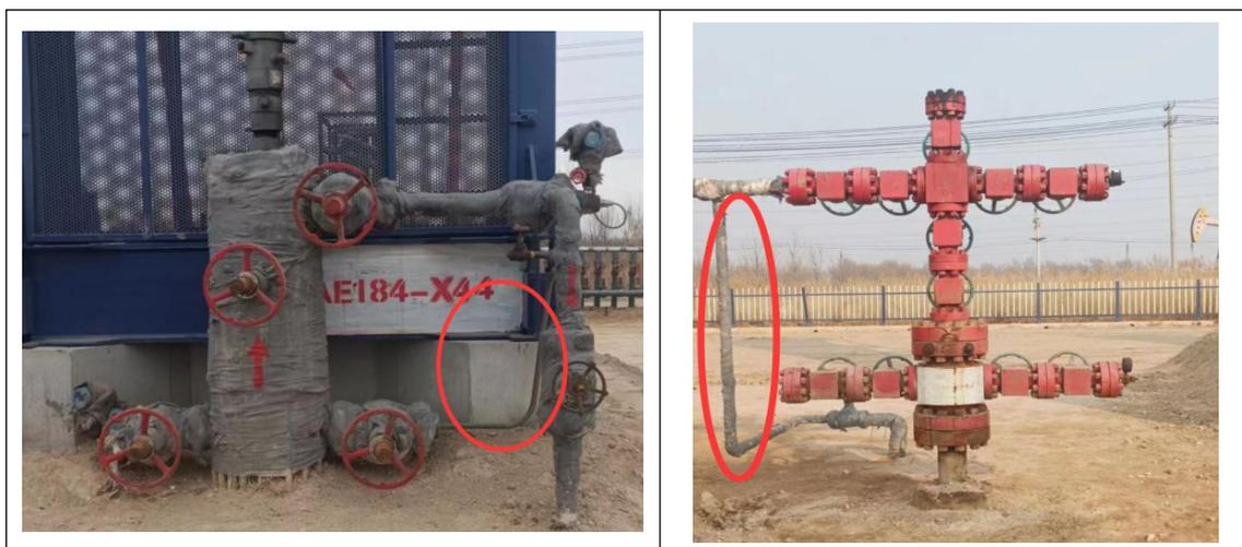
图 5.2-1 不同油井套管气回收装置照片
