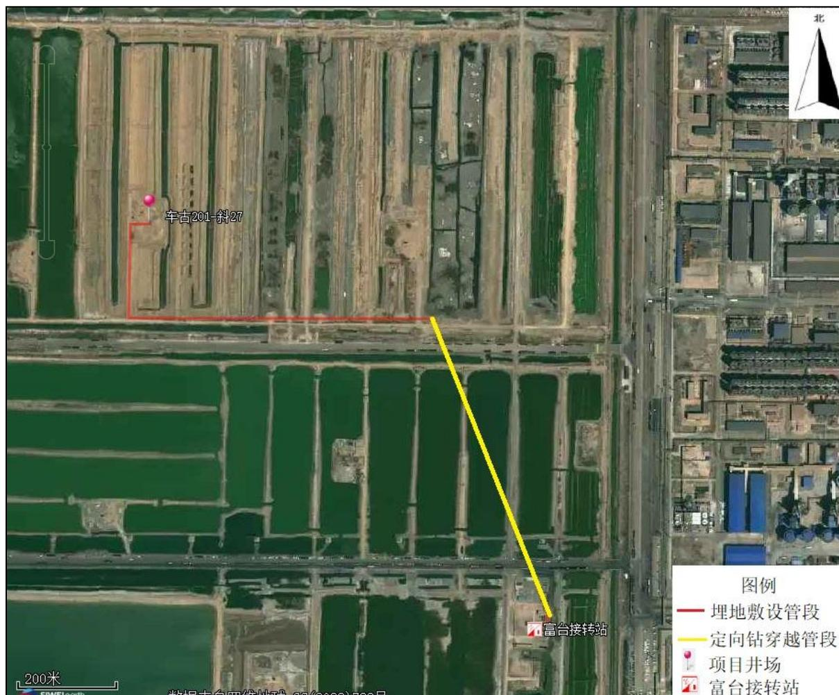
图 3.1-5 新建集油管线走向图
