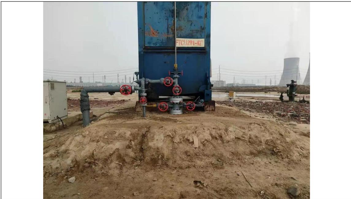
图 5.2-1 油套连通套管气回收装置现场照片
