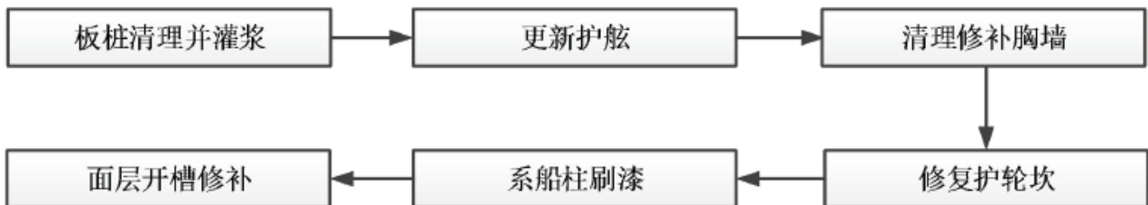
图1 2#、5#、6#、8#、11#泊位码头施工工艺流程图
