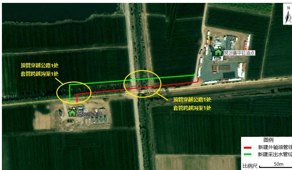
图 3.1-10 新建樊 163 分水分站至樊 28 集中拉油点外输油管线、采出水管线路由图
