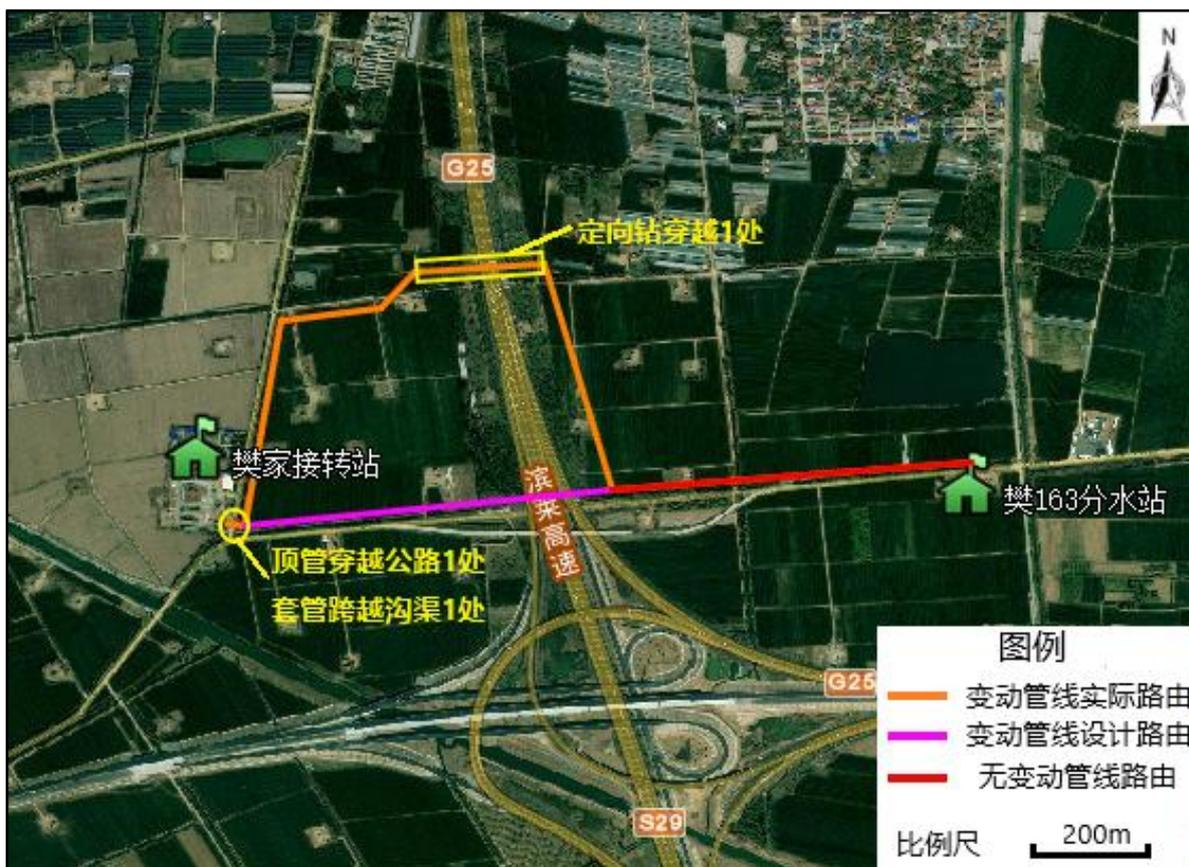
图 3.1-8 新建樊 163 分水站至樊家接转站外输油管线路由图
