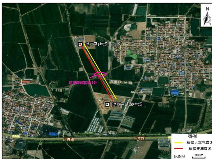
图 3.1-4 新建单井集油管线、天然气管线路由图
