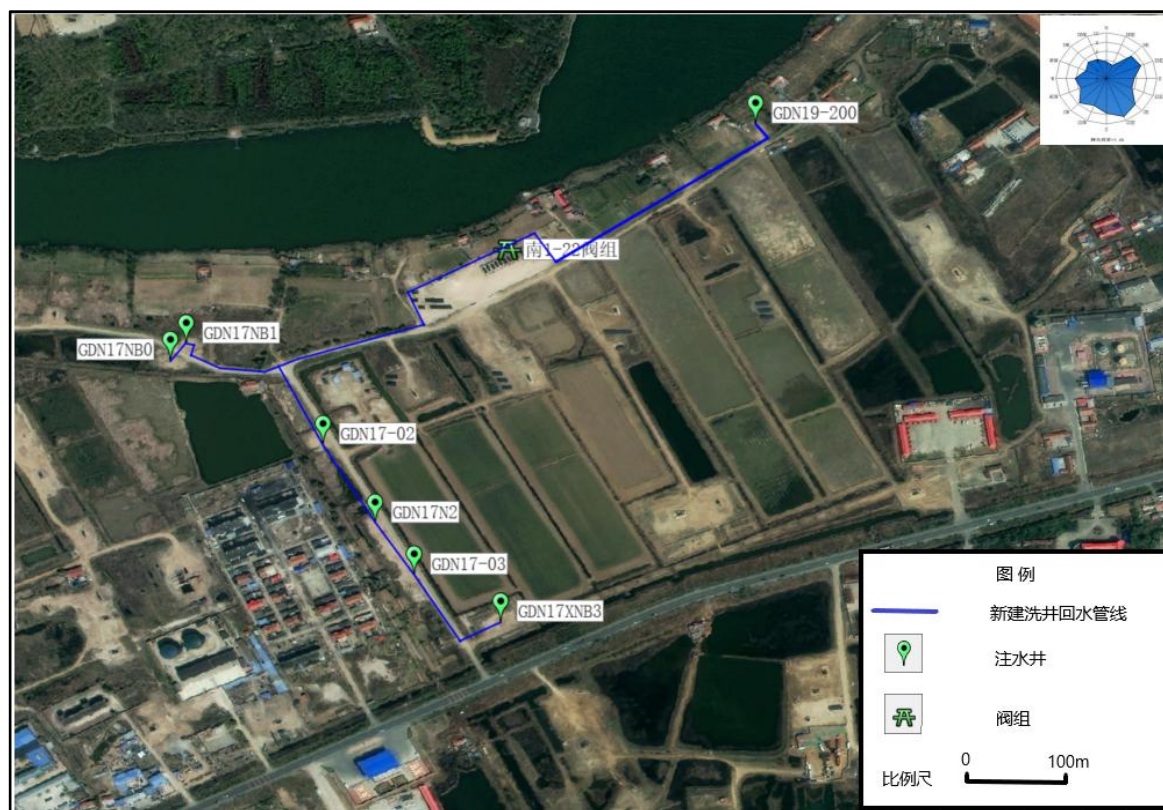
图 3.2-6 管理七区南 1-22 阀组周边新建洗井回水管线
