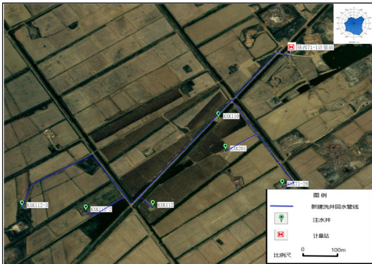
图 3.2-7 管理九区垦西 71-1 计量站周边新建洗井回水管线
