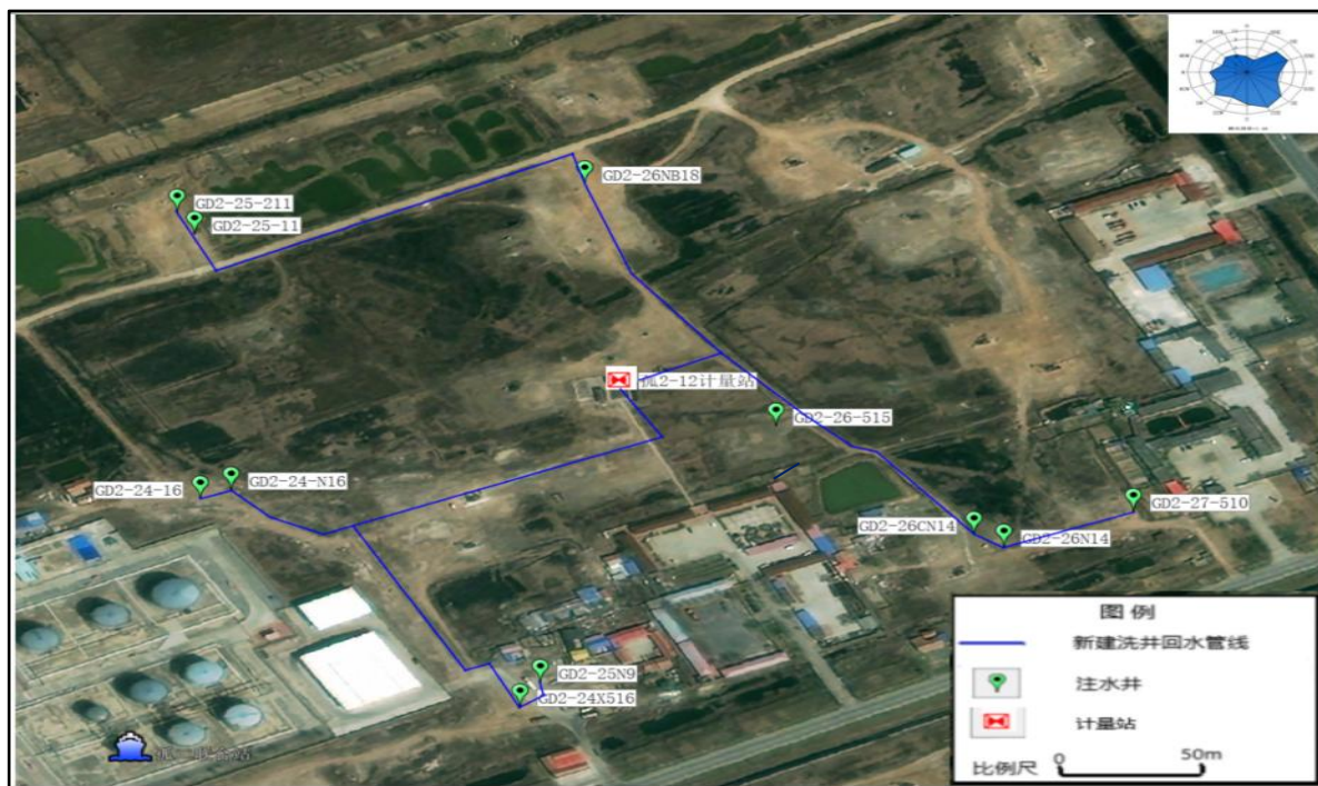
图 3.2-3 管理二区孤 2-12 计量站周边新建洗井回水管线
