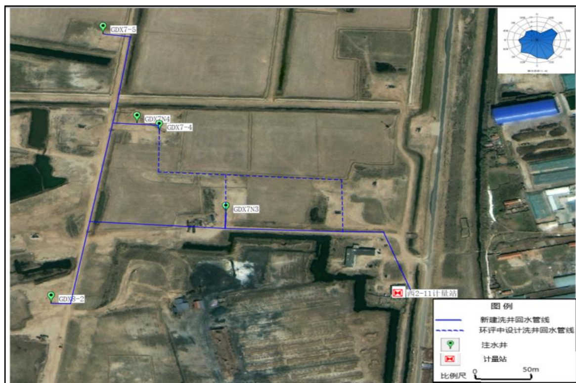
图 3.2-5 管理五区西 2-11 计量站周边新建洗井回水管线
