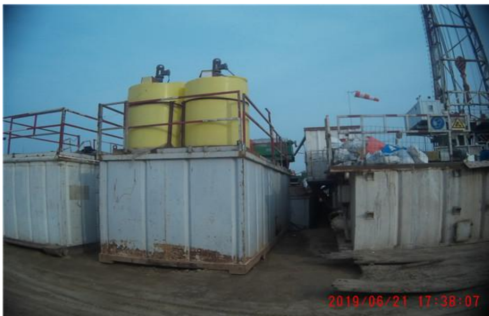
图 4-2 泥浆不落地照片
