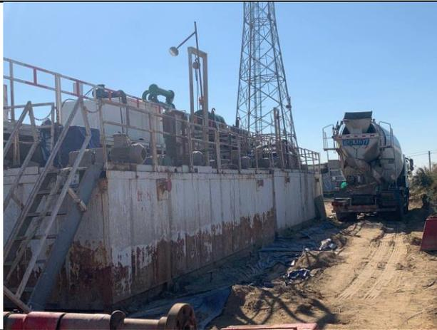
图 4-2 孤古 13-斜 1 侧井钻井现场泥浆不落地装置照片
