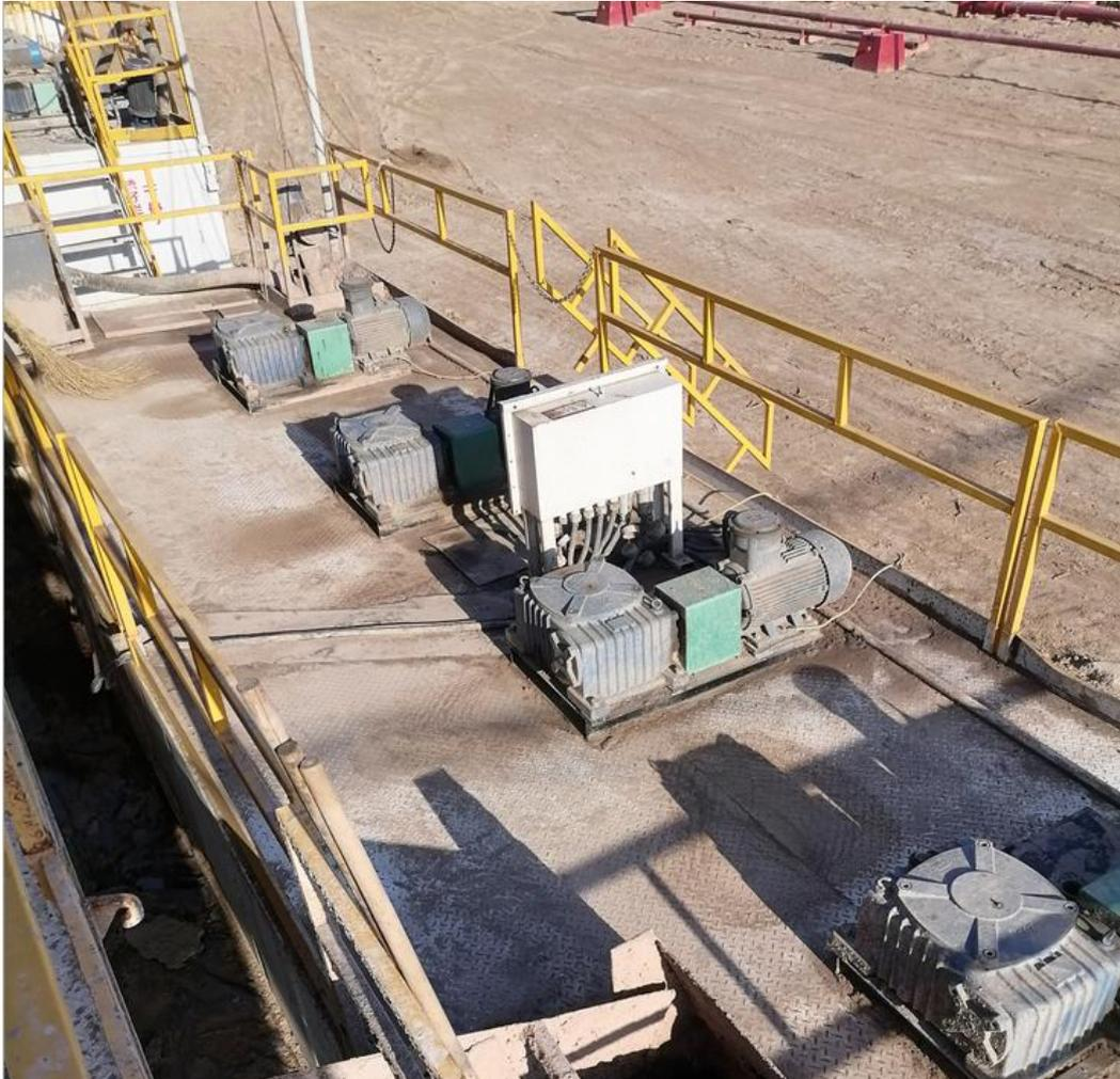
图 8 义古 83 井项目钻井现场泥浆不落地装置照片
