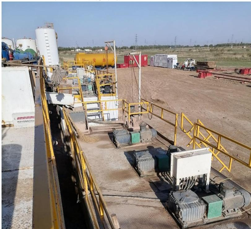
图 6 义古 83 井项目钻井现场泥浆不落地装置照片
