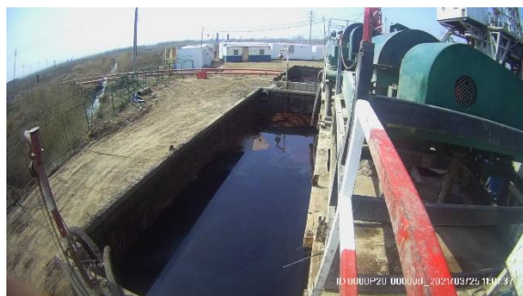
图8 王斜 551 评价井钻井现场泥浆不落地装置照片
