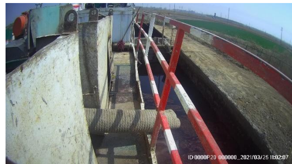
图8 王斜 551 评价井钻井现场泥浆不落地装置照片
