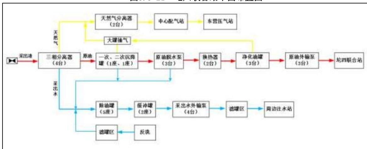
图3.3-22 坨六联合站工艺流程图
