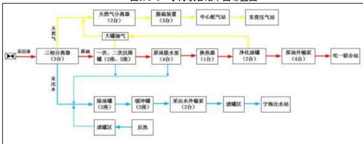
图3.3-10 宁海联合站工艺流程图
