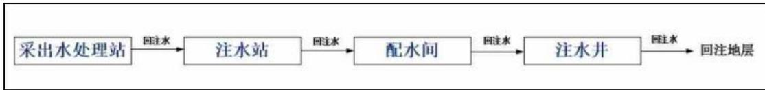
图 3.3-6 注水流程示意图
