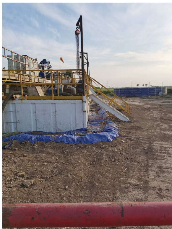
图 2-10 钻井现场泥浆不落地装置照片
