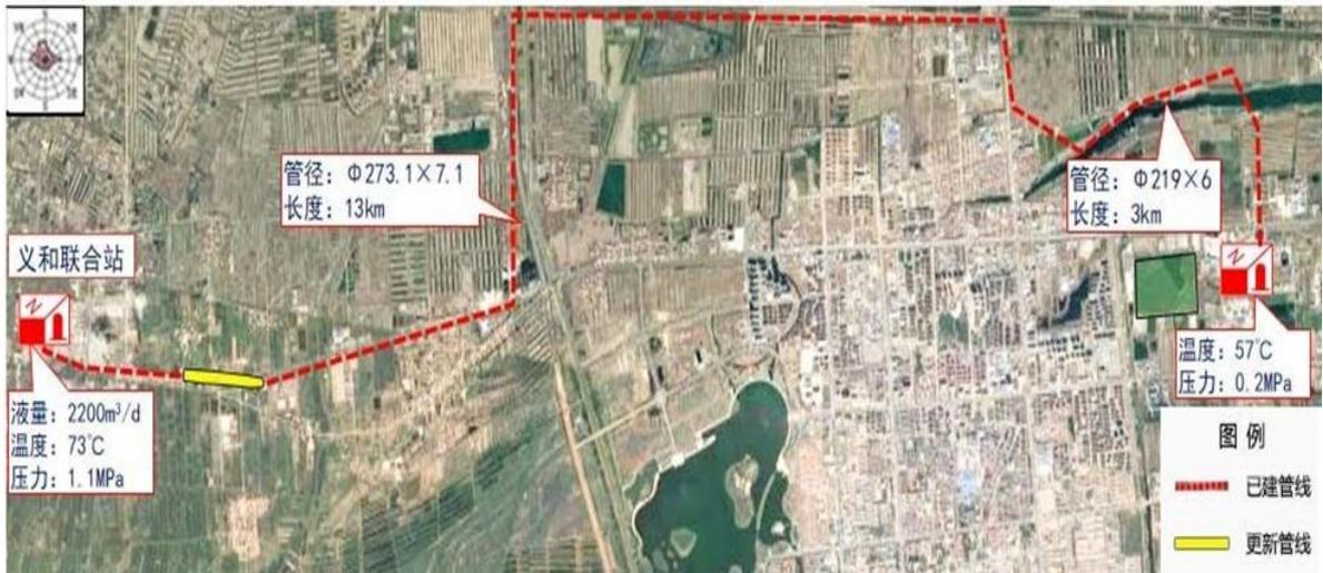
图 2-5 更新工程管线走向示意图
