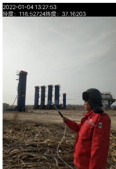
图 5-14 草7-平4、草335--平23 井场无组织废气采样照片
