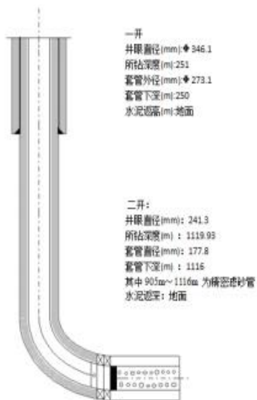
图 2-1 油井井身结构示意图
