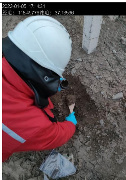
图 5-1 草 705-更平 8 井场土壤采样照片
