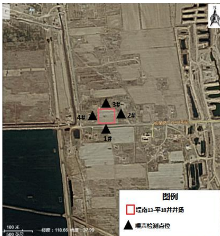
图 5.3-3 噪声监测点位分布示意图
