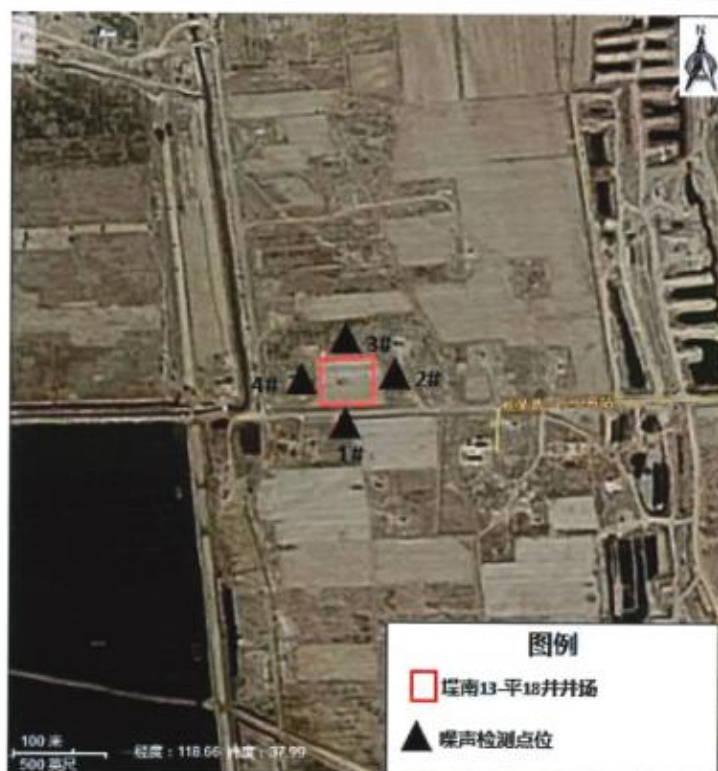
图 3 噪声检测点分布示意图
