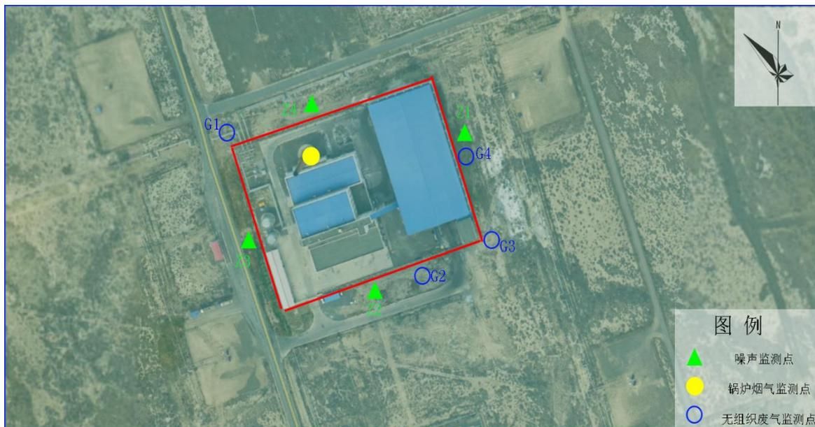
图 6-1 废气及噪声监测布点布设图
